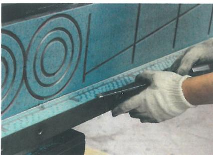
Bild 4: Alle Flachführungen der Hwacheon-Maschinen sind handgeschabt und poliert. So treten selbst bei Schwerzerspannungen kaum Vibrationen auf. Die dadurch erhöhte Stabilität gewährleistet höhere Präzision und Verfügbarkeit sowie längere Standzeiten
